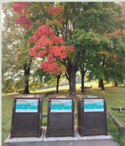
Foto n. 1 - Tre strutture a prova di orso su cassonetti del rifiuto organico da 120 l, comune di Trento; intervento realizzato da Dolomiti Ambiente srl.
